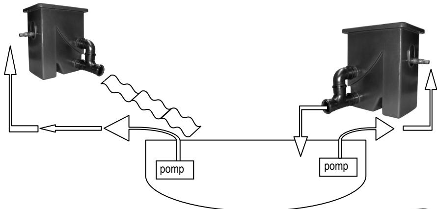
2. Als voorfilter boven een pompgevoed (vortex/meerkamer)filter
