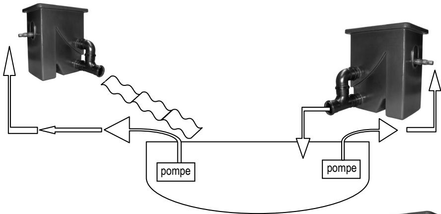
2. En tant que préfiltre au-dessus d'un filtre alimenté par pompe (vortex/multichambres).
