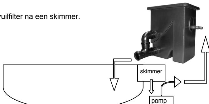
5. Als vuilfilter na een vijverzuiger zodat het gezuiverde water niet wordt afgevoerd maar terug in de vijver kan gaan
