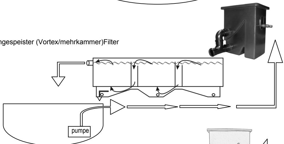
3. Als Rieselfilter in Verbindung mit gleicher Behälter ohne Siebelement.
