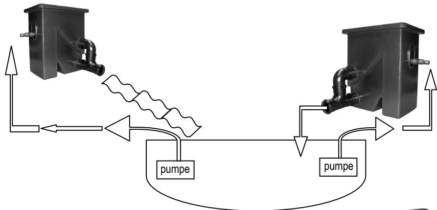
2. Als Vorfilter plaziert auf einen pumpengespeister (Vortex/mehrkammer)Filter
