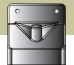
**Position 2 (standard)** représente la longueur minimale de la paroi et est destinée aux pompes jusqu'à  $25 \text{ m}^3/\text{heure}$ . La longueur minimale du flotteur/de la paroi fait en sorte que le niveau d'eau sous le filtre à grille est aussi élevé que possible afin d'éviter que la pompe aspire de l'air à des capacités de pompe relativement élevées.
