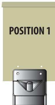
**Position 1** représente la longueur maximale de la paroi et est destinée aux pompes jusqu'à  $\pm 10 \text{ m}^3/\text{heure}$ . La longueur maximale du flotteur/de la paroi fait en sorte que le niveau d'eau sous le filtre à grille ne s'élève pas trop, ce qui fait que la grille est sous eau à des capacités de pompe relativement basses.
