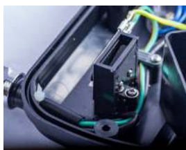
Sikkerhedsafbryder med metalclips til test af UV-C rør
