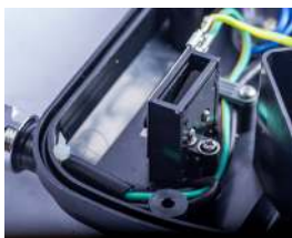
Säkerhetsbrytar med metallclips för test av UV lampa
