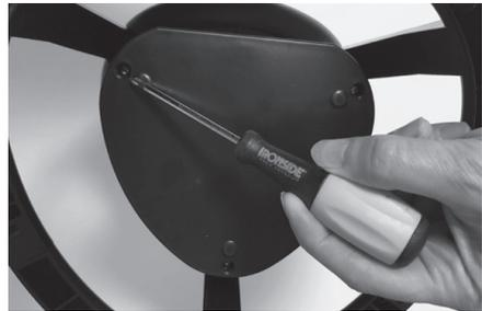
2. Öppna bottenplattan genom att skruva bort de tre skruvarna.
