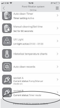
3. Selecteer jouw Pondlink filter en dan stopcontact B, waar het voerapparaat op is aangesloten.
