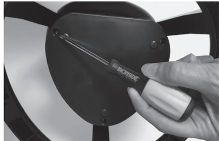
2. Ouvrez le couvercle sous l'écran tactile en retirant les 3 vis.
