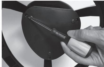
2. Open het beschermdeksel onder het aanraakscherm door de 3 schroeven te verwijderen.
